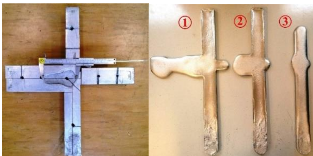
Obrázok 17: Porovnanie stuhnutých odliatkov
