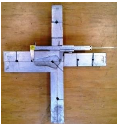
Obrázok 3: Stuhnutý odliatok - stiahnutina v mieste tepelného uzla
