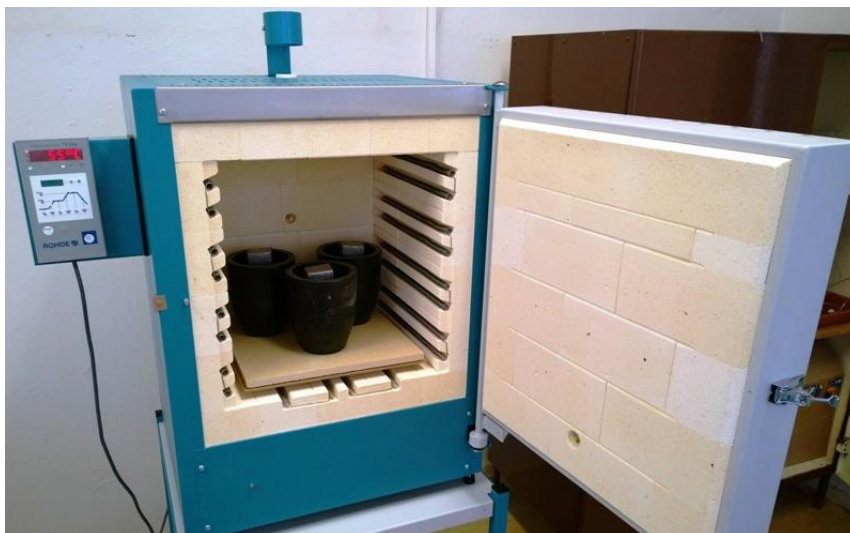
Obrázok 11: Prípravná fáza liatia, Al-Si7 pripravený na roztavenie v grafitových zlievarenských nádobách.
