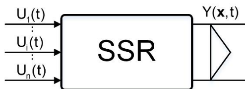
Obr. 3: Systém so sústredeným vstupom a rozloženým výstupom
