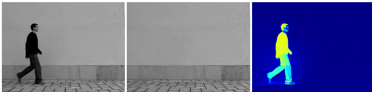
Obrázek 10: Diferenční snímek (vpravo) vstupního obrazu (vlevo) a modelu prostředí (uprostřed)
