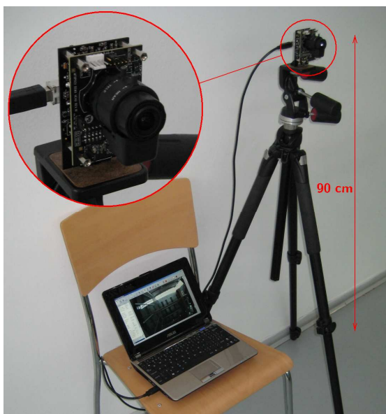
Obrázek 6: Mobilní sestava pro pořízení obrazu chůze osob
