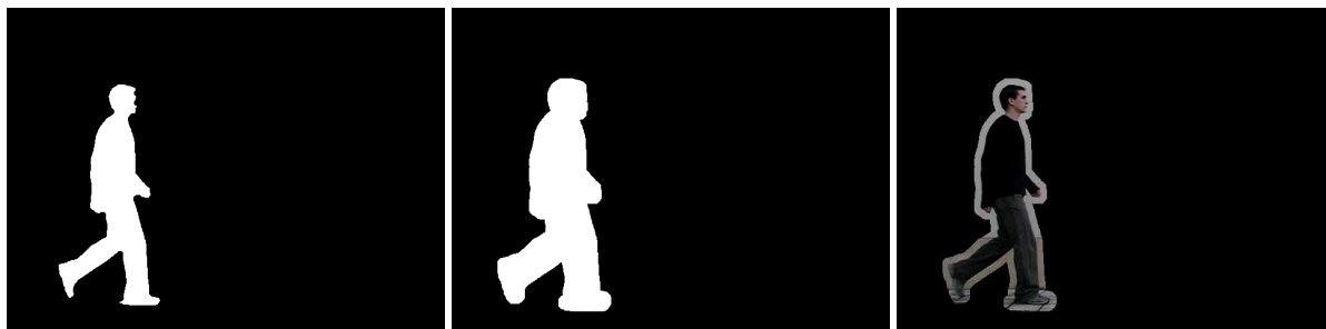
Obrázek 12: Přibližná kontura (vlevo), binární mapa oblasti osoby (uprostřed) a původní obrazová data (vpravo)
