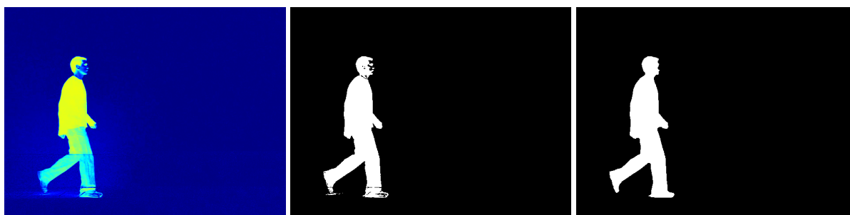
Obrázek 11: Diferenční snímek (vlevo), prahovaný (uprostřed) a upravený morfologickým uzavřením (vpravo)
