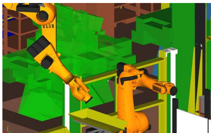
Obr. č. 6: Zásobník je zložený z troch častí s celkovou kapacitou 42 ( 18 + 18 + 6 ) odliatkov na vychladenie.
